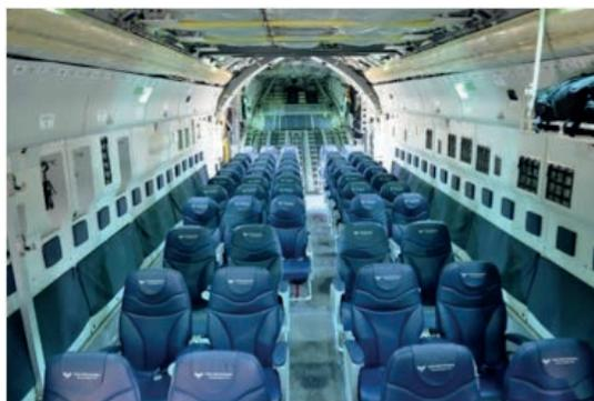
Figura 17 - Configuração da ANV KC-390 com assentos paletizados
