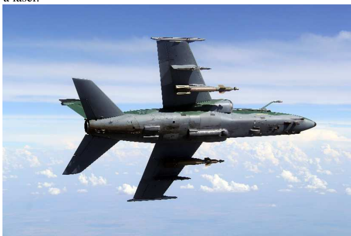
Figura 5 - Aeronave A-1M Falcão configurada com bombas guiadas a laser.
