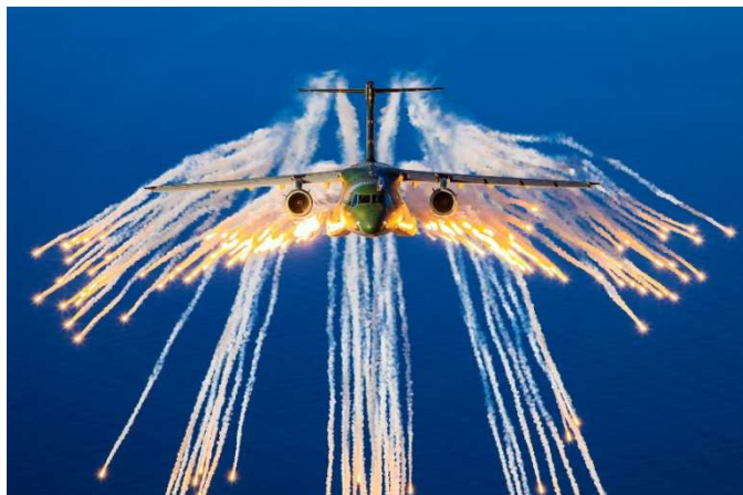
Figura 7 - Aeronave KC-390 Millennium efetuando lançamento de Flares .
